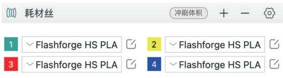
4. 在发送打印任务前注意在弹窗页面确认一下每个颜色选择的通道是否符合自己预期。若通道信息是“？”，说明设备上的耗材尚未配置耗材信息，若通道信息是“空”，说明设备上该通道未安装耗材（注意要确保该槽位的耗材与切片材料种类一致）。
