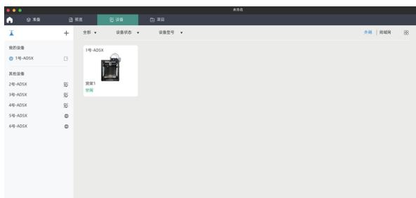
2. 局域网模式下连接打印机需打开打印机【网络模式】-【局域网模式】，切片软件在设备页点击【+】找到对应打印机。选择相应打印机并输入打印机上的设备ID完成连接。
